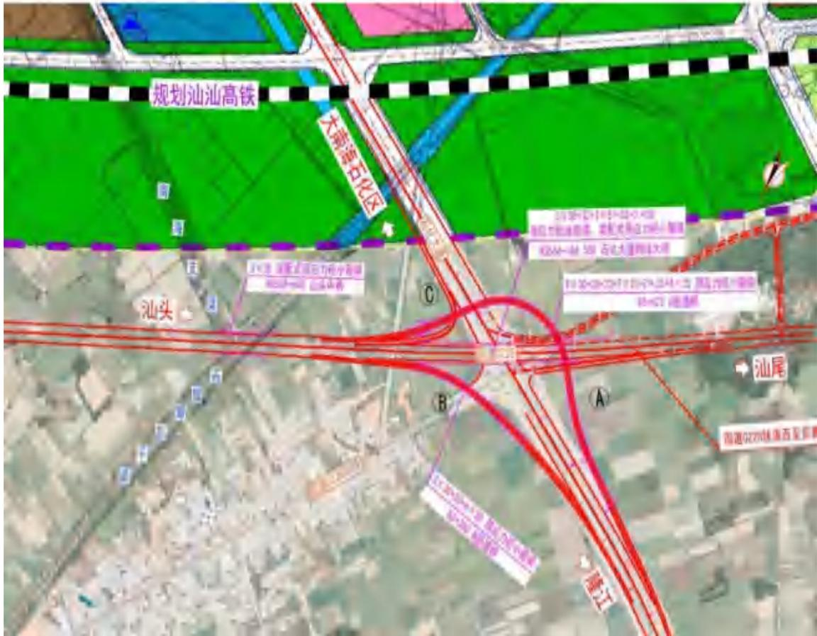
图 2.4.6-2 终点节点跨线桥+定向互通方案示意图
