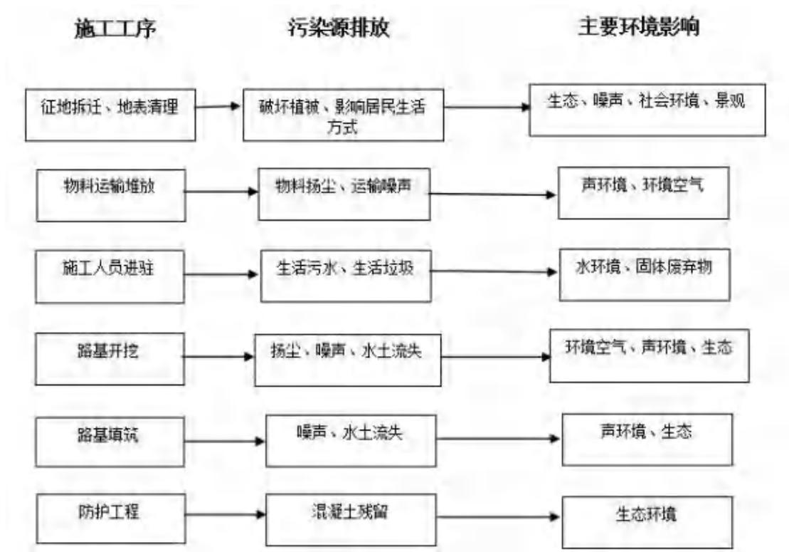
图 2.6.3-1 路基施工工艺及环节产污情况图
