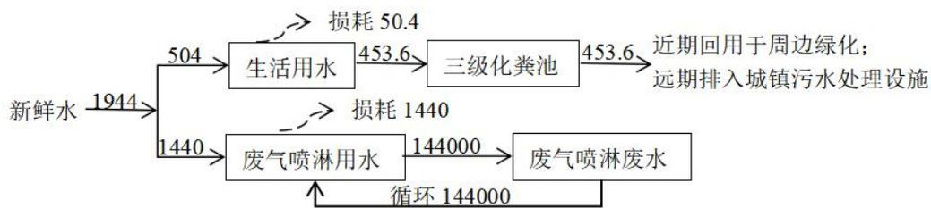
图 2-1 厂区水平衡图 (t/a)
